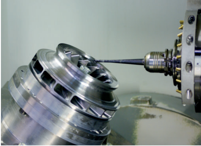
3 Bei der Herstellung eines Verdichterlaufrades entscheidet die Zugänglichkeit des Werkzeugs über die Machbarkeit der Bearbeitung. Eine hohe Stabilität und Rundlaufgenauigkeit sind ebenso erforderlich wie exakte Abstimmung von Substrat, Geometrie und Beschichtung
