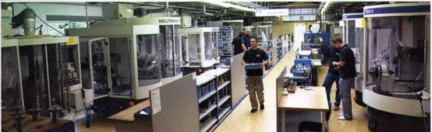
Schleifhalle in Laboratmosphäre: Parkettboden und Ölnebelabsaugung sorgen für eine saubere Fertigung.
